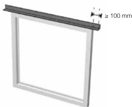
Figure 11 : Pose avec débordement
