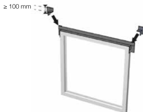
Figure 12 : Pose avec retombées (avec ou sans angles préformés)
