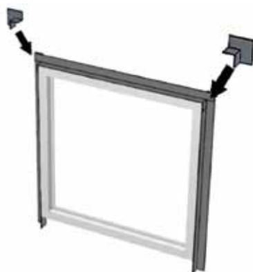
Figure 13 : Pose sur 3 côtés (avec ou sans angles préformés)
